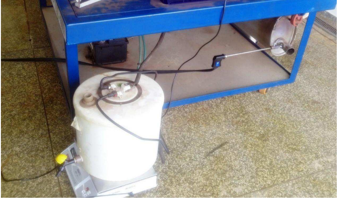
Figura 23- Balança e reservatório de combustível.
