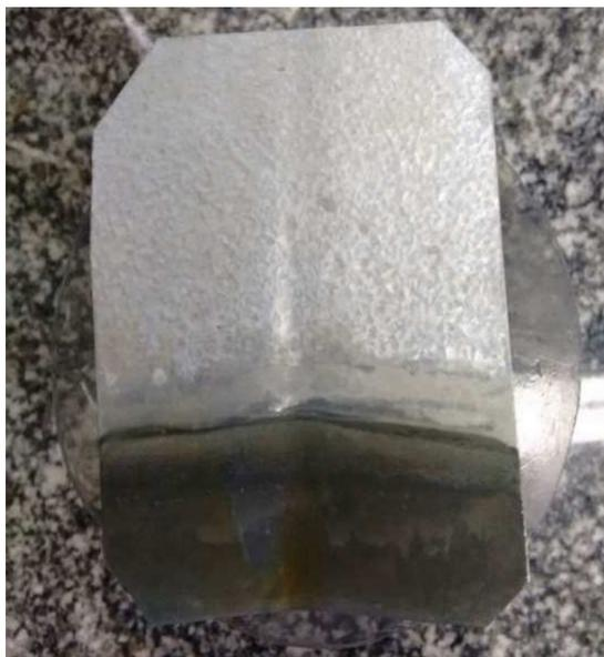
Figura 38 - Chapa galvanizada imersa na glicerina bruta após dois meses.
