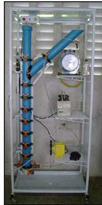
Figura 22 - Biodigestor em escala laboratorial
