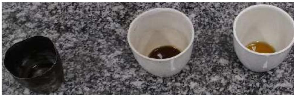
Figura 32 - Cadinhos que foram colocados no forno mufla para teste de combustão espontânea.
