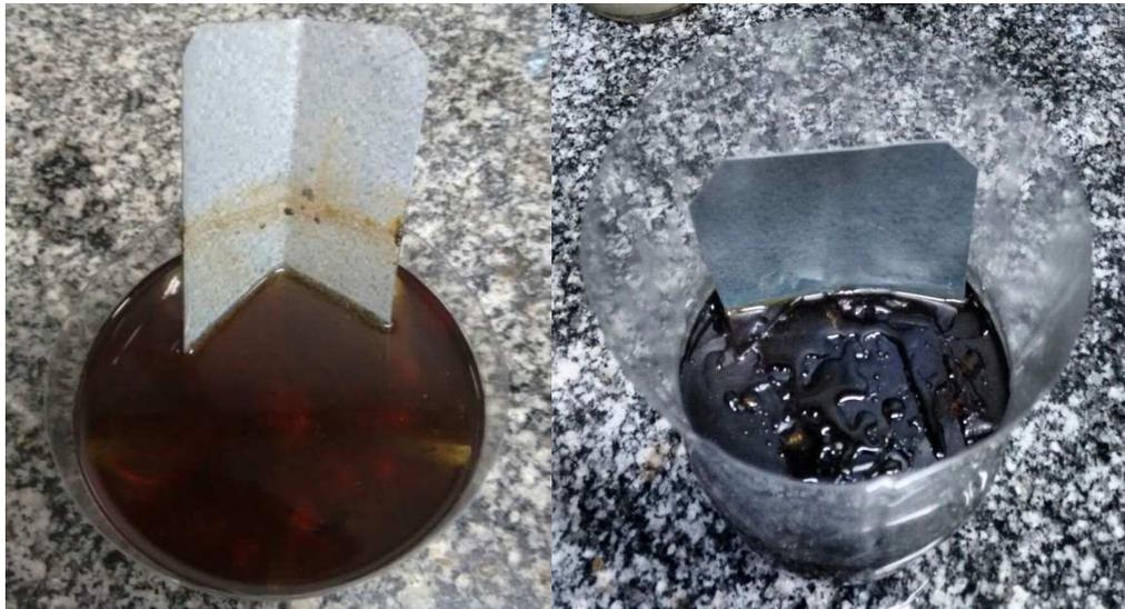
Figura 34 - Chapa de aço galvanizado imersa em glicerina loira (esquerda) e bruta (direita).
