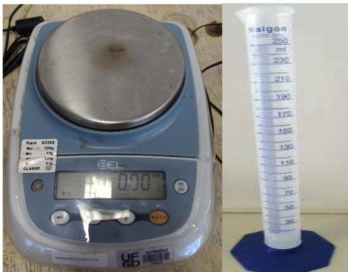
Figura 29 - Balana de preciso – esquerda e proveta graduada – direita.
