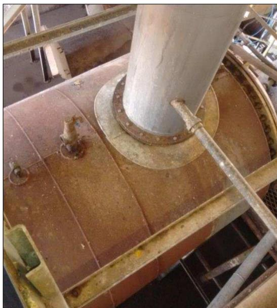
Figura 20 – Duto instalado na parte superior do digestor de vísceras para a captação dos gases/vapor de exaustão (Fonte: Elaborada pelo autor, 2016).
