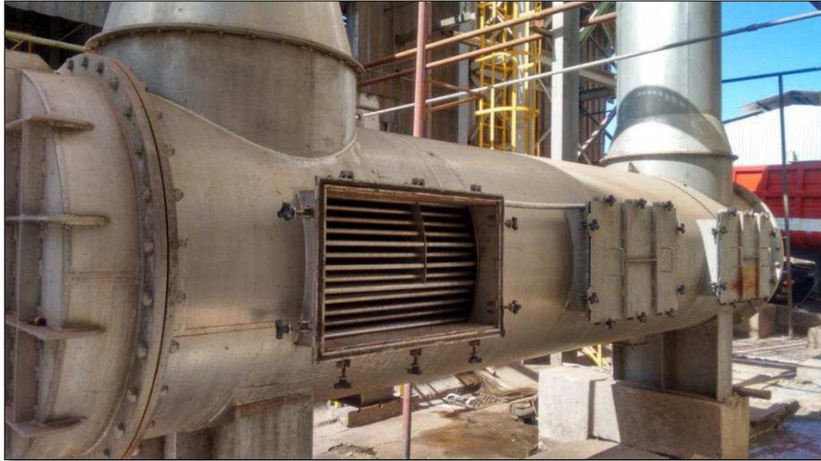
Figura 24 – Trocador de calor casco tubo aberto para observação da posição dos tubos (Fonte: Elaborada pelo autor, 2016).
