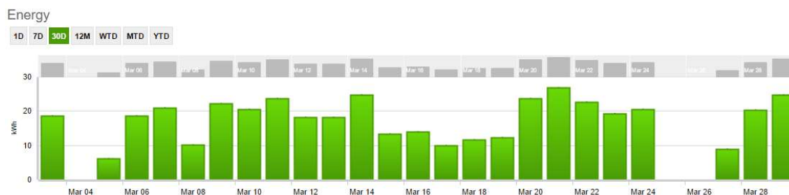
Figura 68. Geração elétrica diária para o Mês de Março/2017 do sistema instalado na UFGD
