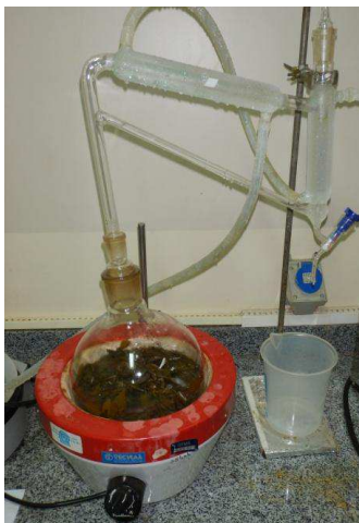
Figura 5: Metodologia utilizada para extração do óleo essencial de A. edulis .
