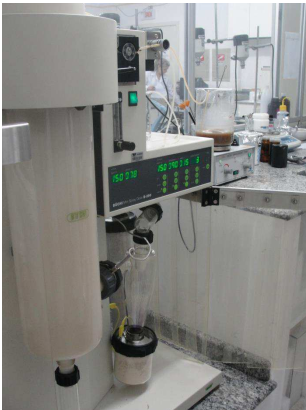
Figura 2: Spray dryer do laboratório de farmacologia da UNIVALE – Itajaí- S.C.
