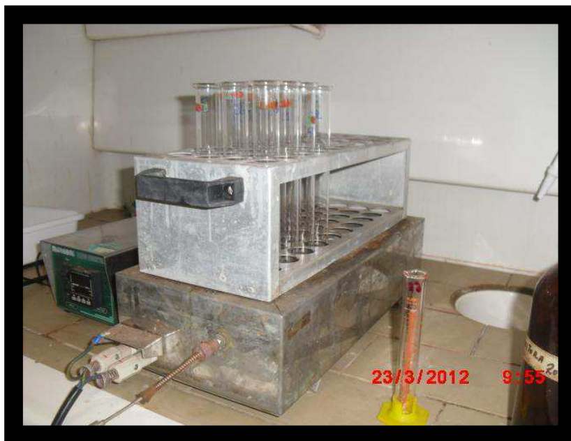
Figura 3 – Bloco digestor utilizado para digestão das amostras, para em seguida realizar a destilação e obter a proteína total nas amostras de queijos.
