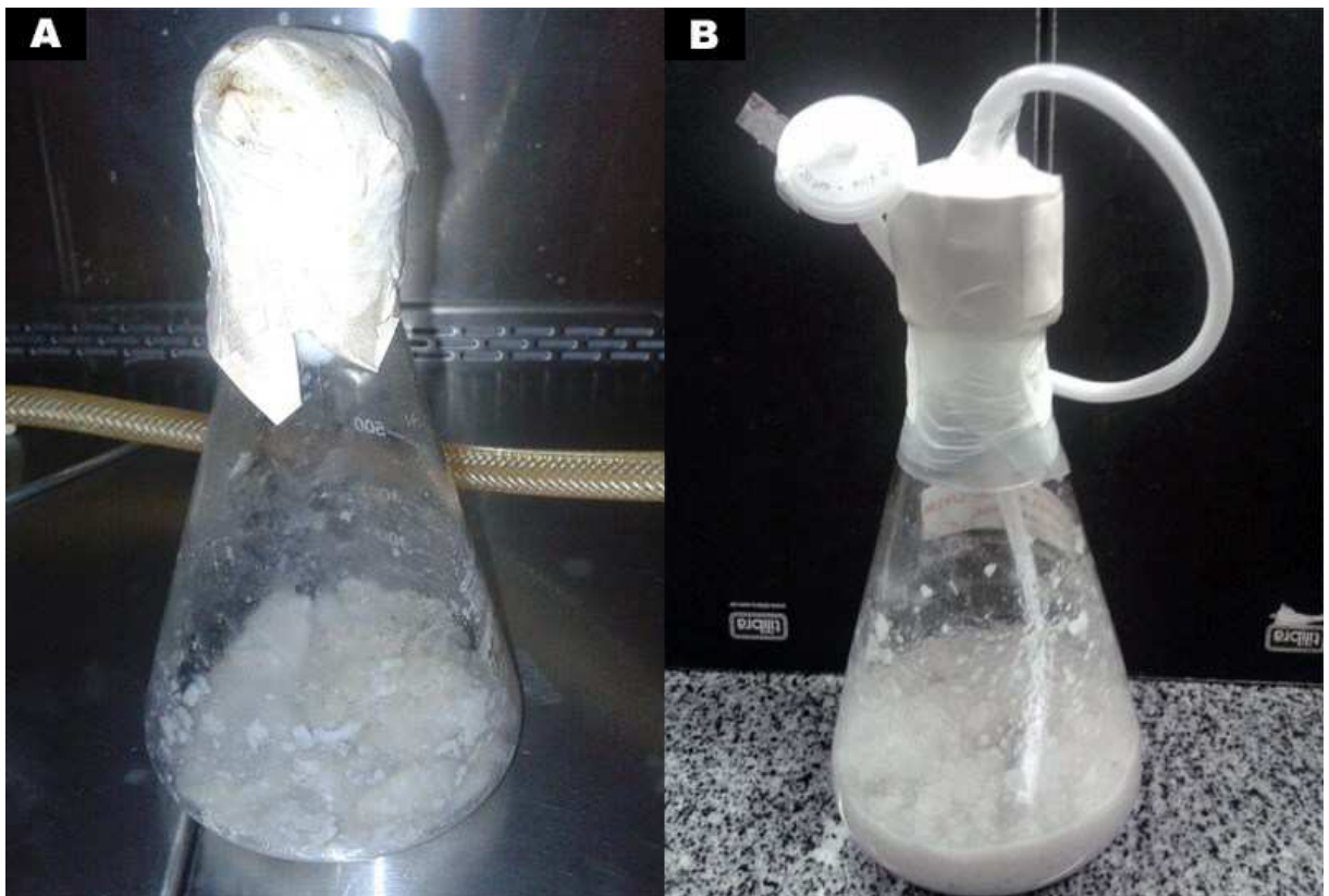
Figura 12. A - concentrado proteico após pasteurização sem a presença de inóculo, B - biorreator finalizado com a presença de inóculo e substrato.
