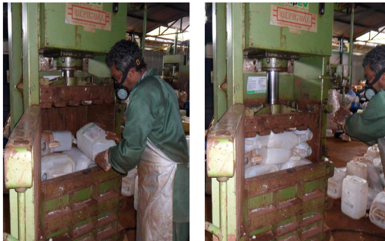
Figura 12: Processo de prensagem de embalagens vazias de agrotóxicos Fonte: Foto do autor
