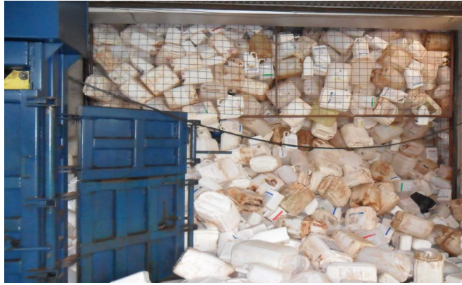
Figura 11: Sistema de saída das embalagens através de aberturas na grade de contenção Fonte: Foto do autor
