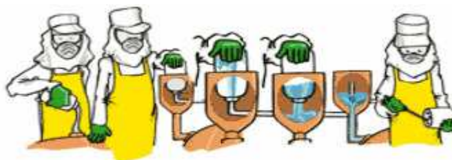
Figura 4: Esquema para a realização da lavagem sob pressão de embalagens vazias de agrotóxicos Fonte: INPEV, 2010
