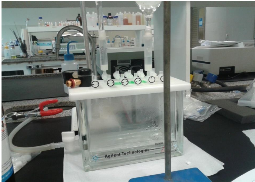
Figura 11 extração em fase solida. Imagem visual dos cartuchos C-18
